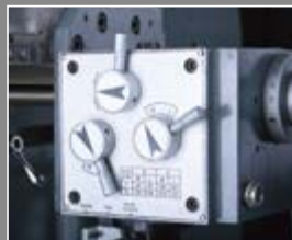
工作台走刀器 • 自动走刀 • 电机带X轴、Y轴工作台齿轮式进刀 Table power feeder • Automatic • Motor with gear table feed X-Axis
