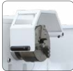
主轴孔径 52mm D1-5 Spindle bore
